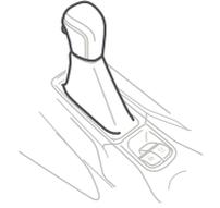
Nota: al mover la palanca entre P y D, el vehículo deberá estar detenido y el pedal del freno está pisado.
